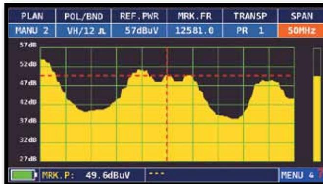
DARSTELLUNG EINES SCPC TRANSPONDER MIT FOLGENDEN PARAMETERN
