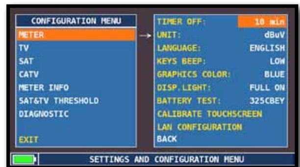
NAVIGIEREN SIE IM LAUTSTÄRKE-BILDSCHIRM DAS "KONFIGURATIONS MENÜ" UND DORT AUF "METER" UND SETZEN SIE DEN GEWÜNSCHTEN WERT FÜR "TIMER OFF". DAS MESSGERÄT SCHALTET SICH NACH 5 ODER 10 MINUTEN INAKTIVITÄT AUS. DRÜCKEN SIE EINE BELIEBIGE TASTE UM DAS AUTOMATISCHE AUSSCHALTEN ZU VERHINDERN.
