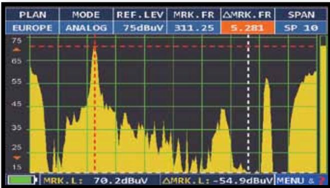
C/N MESS-MODUS: "IM KANAL". DAS TRÄGER/RAUSCH-VERHÄLTNIS WIRD ZWISCHEN DEM PEGEL DES TRÄGERS (ROTE MARKIERUNG) UND DEM RAUSCHEN ZWISCHEN DEM FARB-UNTERTRÄGER UND TONTRÄGER DES KANALS (WEISSE MARKIERUNG) GEMESSEN.
