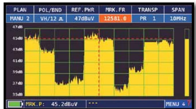
DARSTELLUNG EINES SAT SCPC TRANSPONDERS (10 MHz SPANNE).
