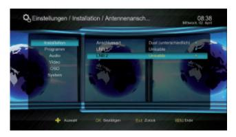
Einstellung der Unicable-Frequenz im Receiver:
