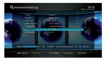
→ Um die Frequenz einzugeben, gehen Sie mit dem Cursor auf den Punkt IF Frequenz. Die Frequenz kann mit Hilfe der Zahlentasten auf der Fernbedienung eingegeben werden.
