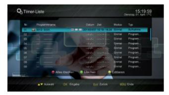
Hier haben Sie zusätzliche Optionen über die Farbtasten Ihrer Fernbedienung. Sie können mit der roten Taste alle programmierten Timer löschen, mit der grünen Taste, den markierten Timer löschen und mit der gelben Taste den markierten Timer öffnen um ihn nochmals zu bearbeiten.
