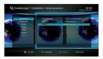
Satellit: wählen Sie hier den Satelliten aus, den Sie ansteuern möchten Transponder: wählen Sie hier den entsprechenden Transponder aus Motoreinstellung: wählen Sie hier die Steuerung aus, mit der der Motor angesteuert werden kann (Goto XX, DiSEqC 1.2) oder deaktivieren Sie die Steuerung
