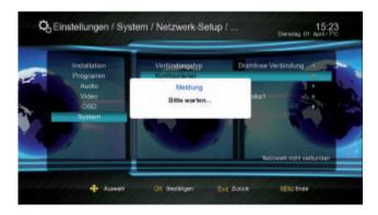
Wählen Sie den Menüpunkt "Schlüssel" und bestätigen mit OK. Fügen Sie mit Hilfe der jetzt angezeigten Bildschirmtastatur Ihren Zugangscode ein gehen und bestätigen mit der blauen Taste. Gehen Sie zu "Verbinden" und drücken "OK".
