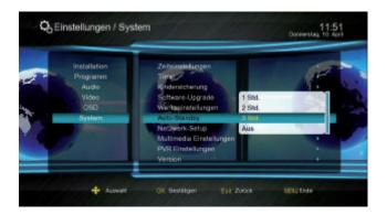
Das Gerät schaltet im Auslieferungszustand gemäß EU-Vorschrift nach 3 Stunden ohne Bedienung aus.
