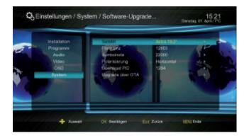
Um das Update über Satellit zu starten, wählen Sie bitte die Zeile "Upgrade über OTA" und bestätigen mit "OK". Es öffnet sich ein neues Fenster in dem die neue Software-Version angezeigt wird.
