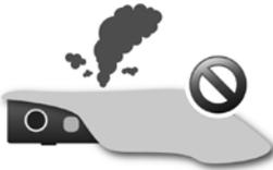
Achten Sie darauf, dass keine Belüftungsschlitze des Gerätes verdeckt werden, um eine ausreichende Belüftung zu garantieren.
