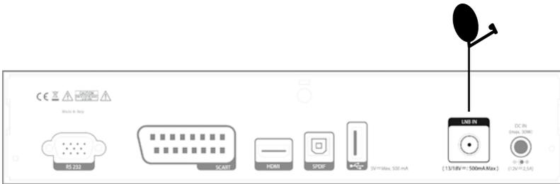
Schließen Sie das Satellitenantennenkabel an die **LNB IN** Buchse an.
