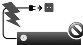
Bei Gewitter oder bei Nichtgebrauch für längere Zeit, trennen Sie das Gerät von der Netzsteckdose und von der Antenne. Dadurch werden Schäden am Gerät vermieden, die durch Blitzschlag oder Spannungsspitzen hervorgerufen werden können.
