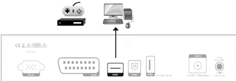
Schließen Sie das HDMI Kabel an die **HDMI** Buchse und an einen HDMI Eingang Ihres TV Gerätes an.
