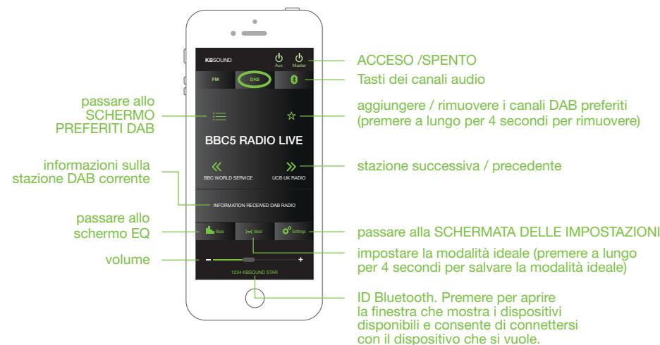
L'applicazione in ciascun dispositivo Bluetooth (iOS / Android) consente di memorizzare il proprio elenco di FM e DAB preferiti. Questi elenchi sono controllati solo dall'Applicazione in ciascun dispositivo, senza utilizzare il telecomando in dotazione.
