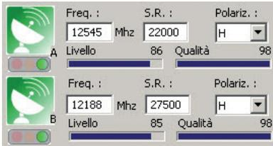
Avete la possibilità di installare due transponder di uno o due satelliti differenti. Nel caso di uso di due LNB differenti prego controllare di non sovraccaricare il modulo prelevando troppa corrente.
