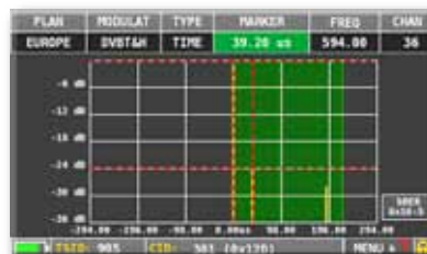
MISURA ECHI nelle Reti SFN, con Risposta all'Impulso in tempo reale, in verde l'Intervallo di Guardia
