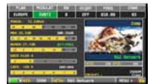
Tutte le misure, PID A/V l'immagine e i settaggi in una sola schermata
