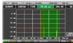
MISURA ECHM nelle Reti SFN, con Risposta all'Impulso in tempo reale, in verde l'Intervallo di Guardia
